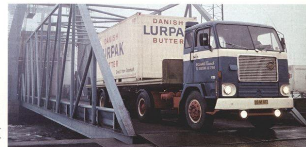
F 88-32 som dragvagn för semitrailer avsedd för containertransport. TD 100, R 60, dubbelväxel. Lastförmåga ca 19,5 ton.
