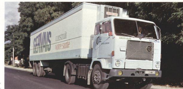
F 88-32 dragvagn för semitrailer. TD 100, SR 61, dubbelväxel. Lastförmåga ca 18 ton.
