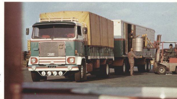
G 88-56 4x2 med treaxlig släp försett med skåp för fjärrtransport. TD 100, SR 61, dubbelväxel. Lastförmåga ca 28 ton.
