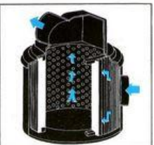
Groot luchtfilter met papieren filterelementen
